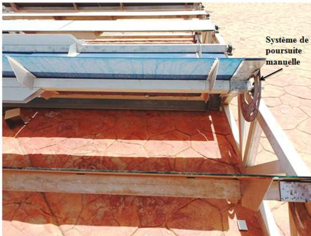
Figure V.08 : système de poursuite manuelle mis en place sur les concentrateurs.
