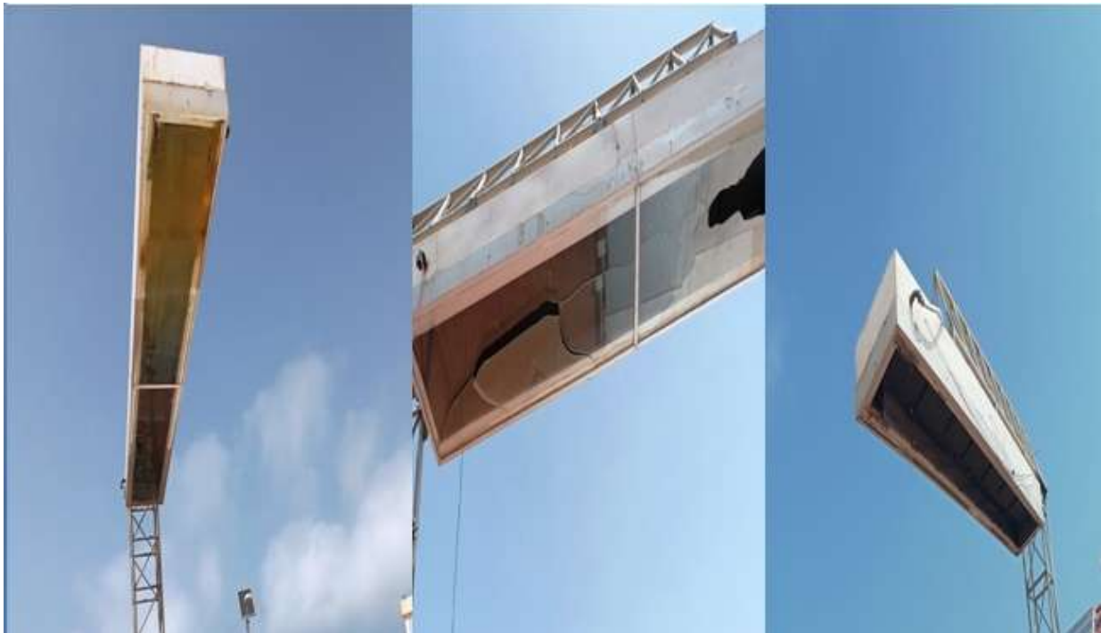
Figure V.19 : Etats du récepteur durant les tests.
