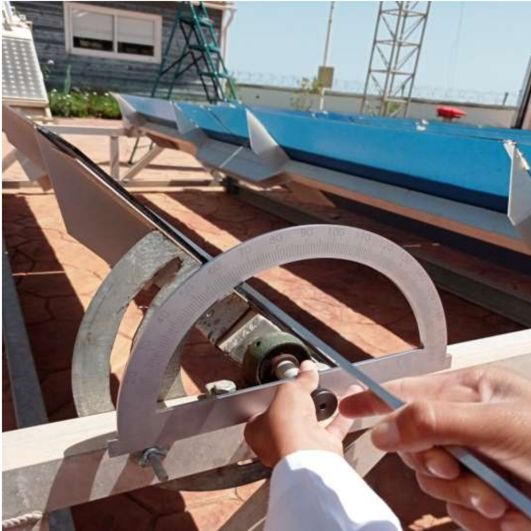
Figure V.13 : mesure de l'angle d'inclinaison.
