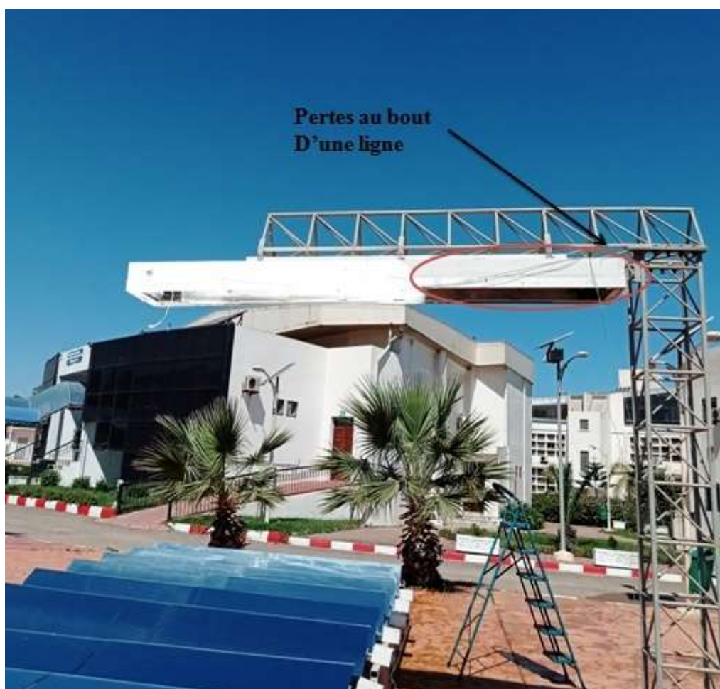
Figure V.18 : Pertes au bout d'une ligne du récepteur.
