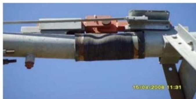
Figure I.7 – Élément de liaison entre travée, Photo IRRAGRIS
