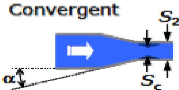
**FIGURE 4** : Schéma d'une conduite convergente
