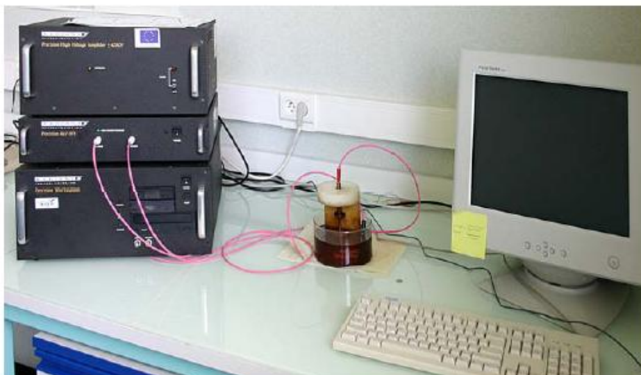
Figure 4: Photo de l'appareil de mesures des propriétés ferroélectriques Radiant, Precision HV Amplifier \pm 4000V
