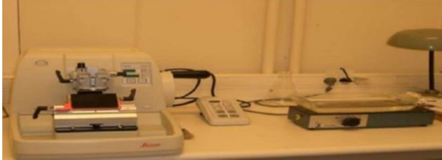
Figure 21 : Photographie d'un microtome à gauche et du bain Marie à droite (Lakabi, 2017).
