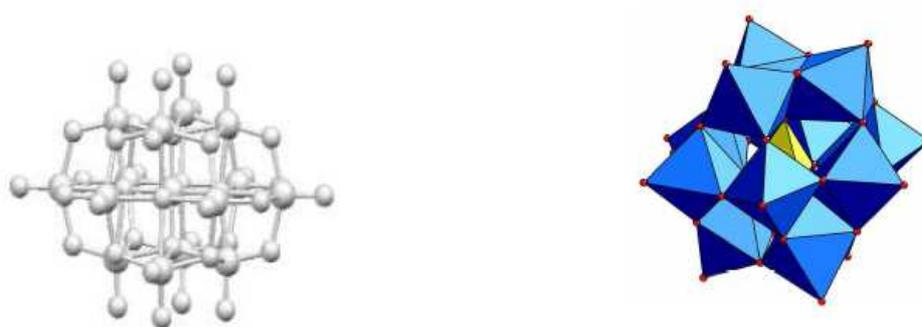
Figure 15 : Structure de Keggin  $[XM_{12}O_{40}]^{n-}$
