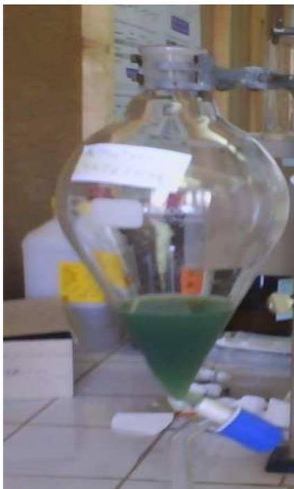
**Figure 31:** Dispositif d'extraction de l'hétéropolyacide.
