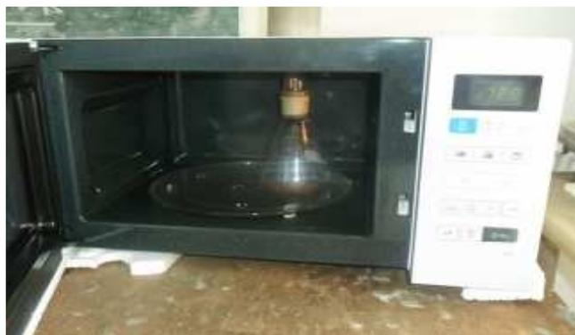
**Figure 21** : Dispositif de la réaction de Biginelli sous micro-ondes.
