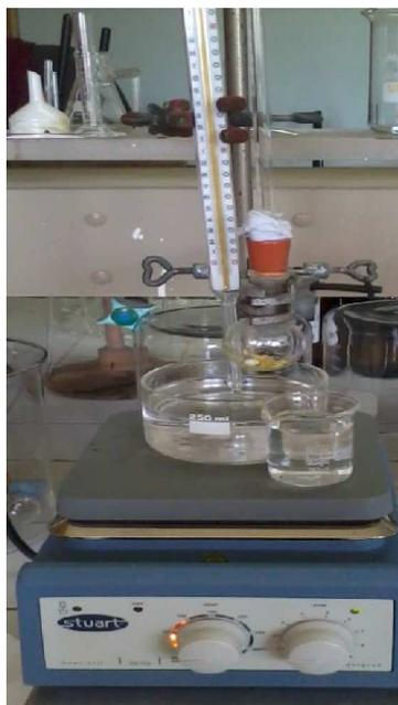
**Figure 19 :** Dispositif de la réaction de Biginelli avec chauffage conventionnel.
