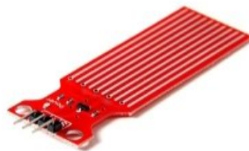
Figure II.32: Capteur de niveau d'eau.
