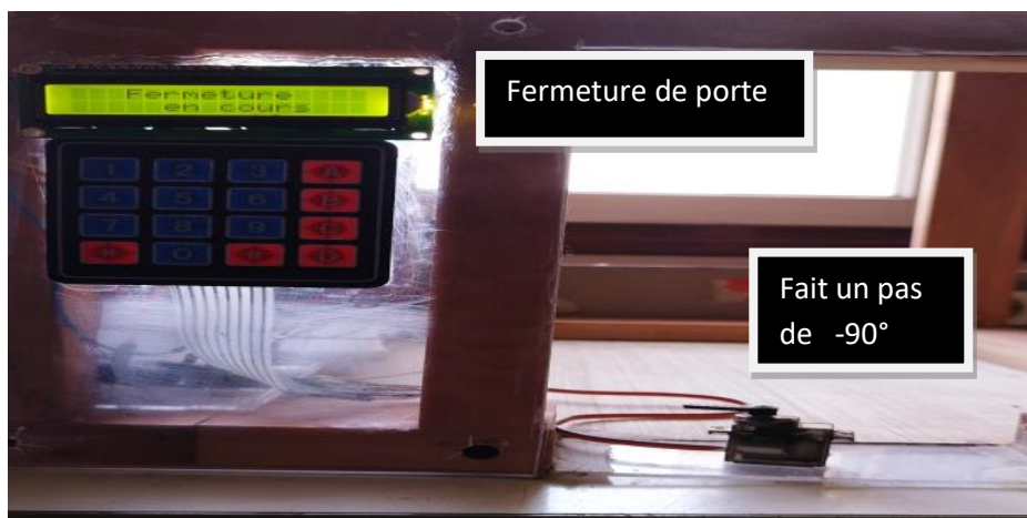
Figure III.40: Test de fermeture de la porte du bâtiment d'élevage.
