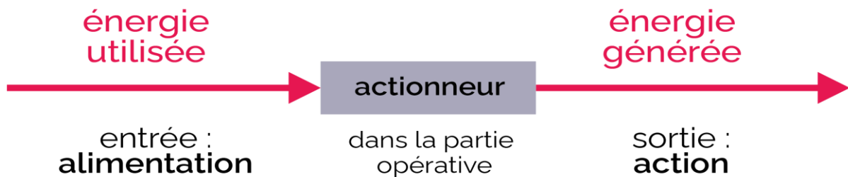
Figure II.21: Principe d'un actionneur [4].
