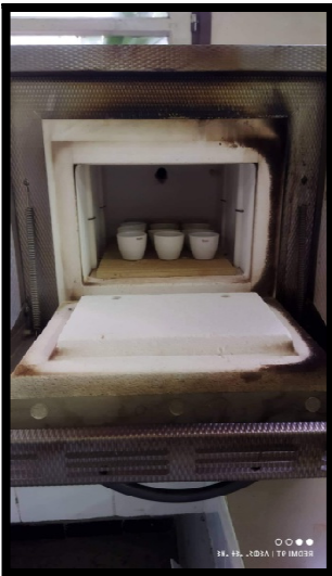
Figure 18: mise au four à 450°C
