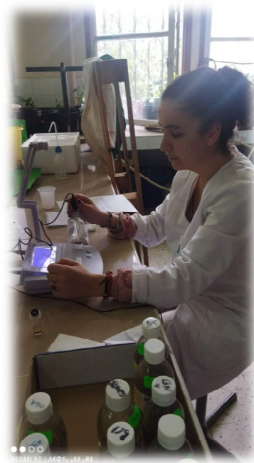
Figure 14: Mesure du pH avec un pH-mètre
