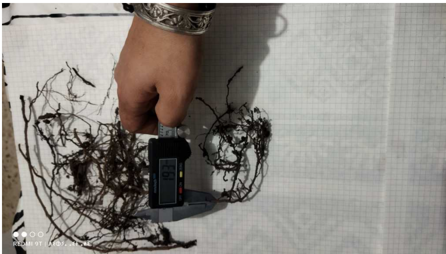
Figure 12: Mesure du diamètre des racines avec un pied à coulisse électronique.
