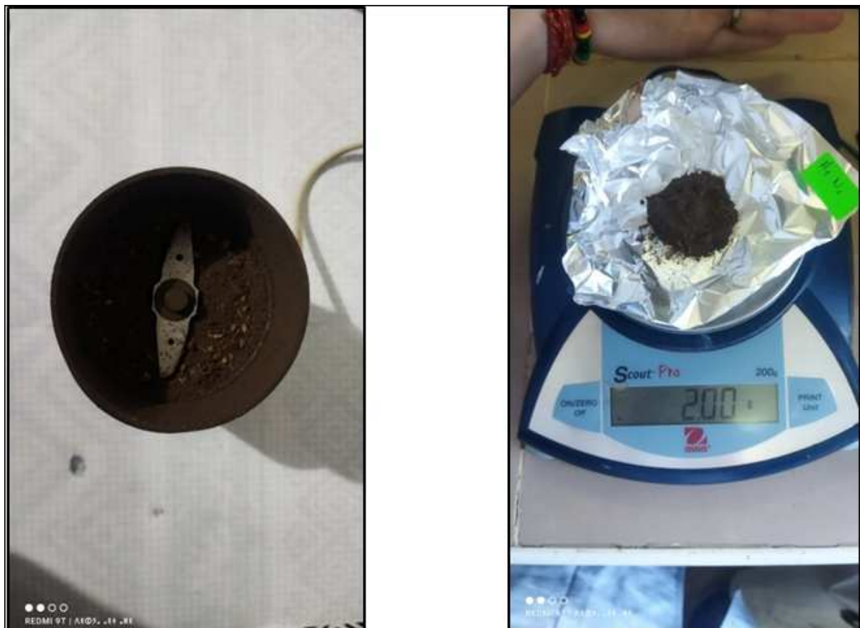
Figure 19: Broyage et pesée de la poudre des racines.
