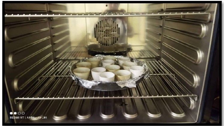
Figure 16: mise à l'étuve 16h à 220°C
