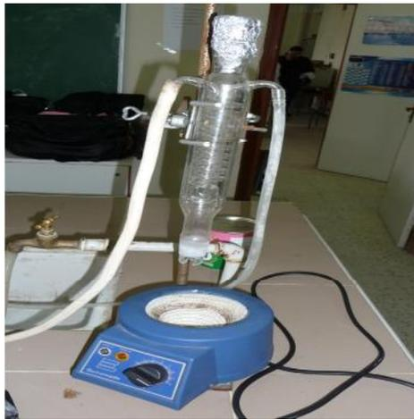
**Figure 17: Réfrigérant à reflux ( photo originale)**
