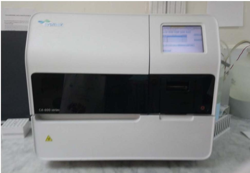
**Figure 27 : Analyseur de coagulation automatique type « SYSMEX CA-600® »**
