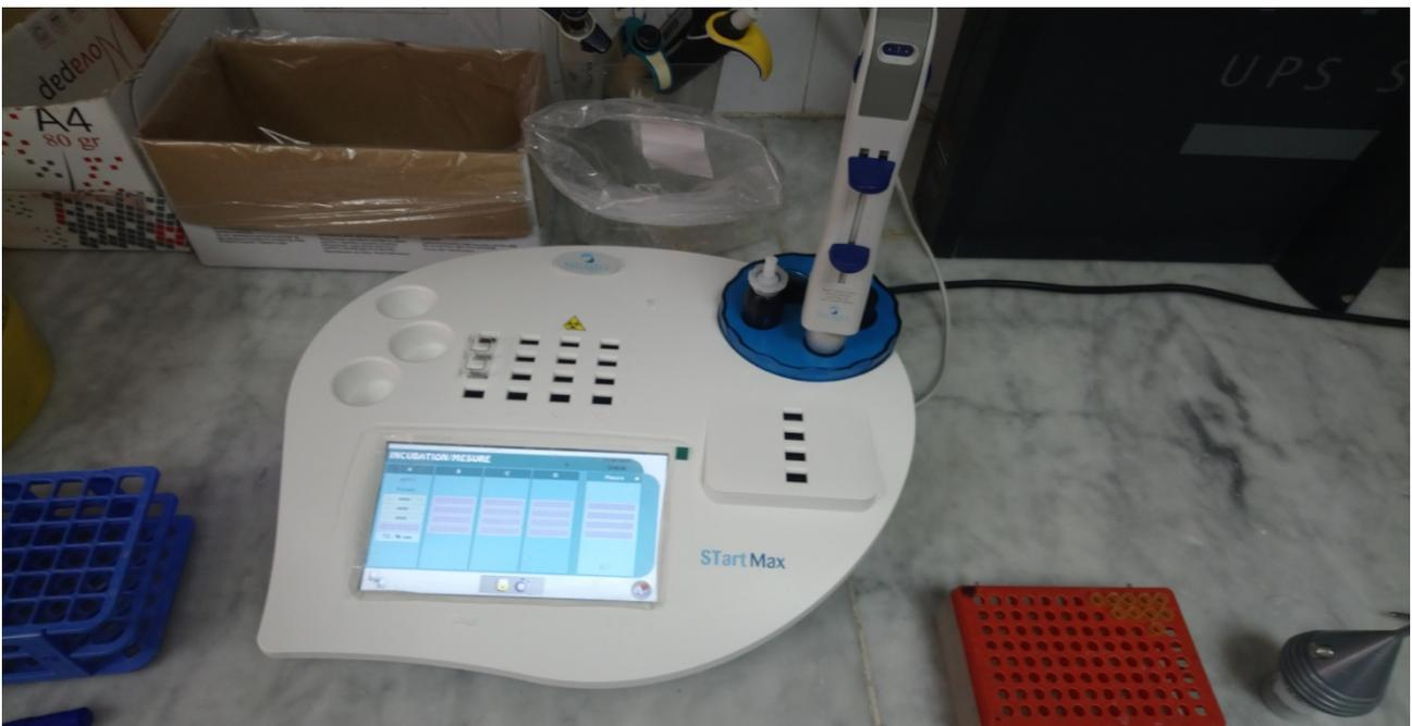
**Figure 26 : Analyseur de coagulation (TCK) semi-automatique « STart Max® »**
