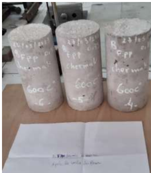
Figure IV.10 : L'aspect des éprouvettes cylindriques du béton de fibres de polypropylène à la sortie du four.
