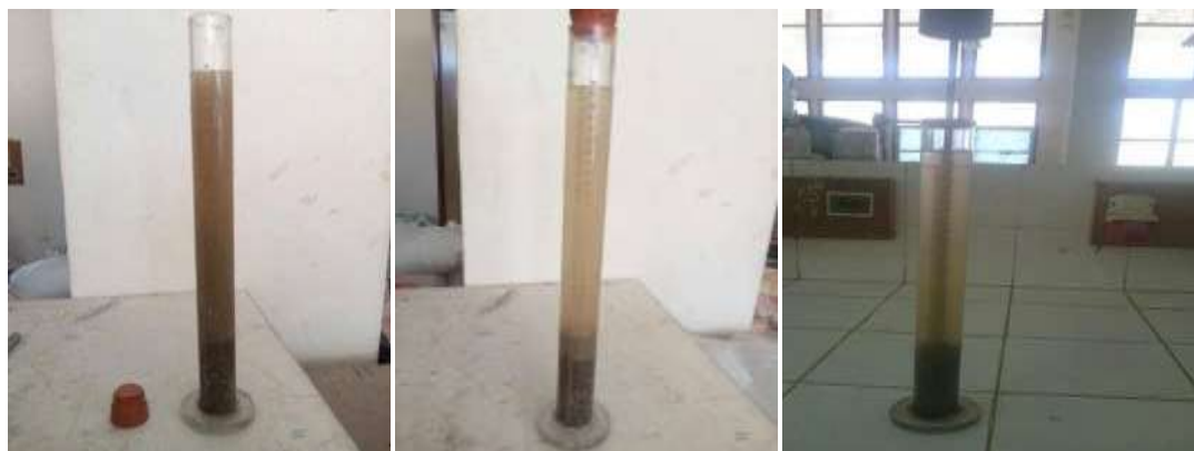
Figure.III.9: Essai de l'équivalent de sable.
