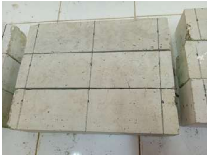
Figure. IV.21: L'aspect des éprouvettes prismatiques du béton mixte (BFM,PP) à la sortie du four.
