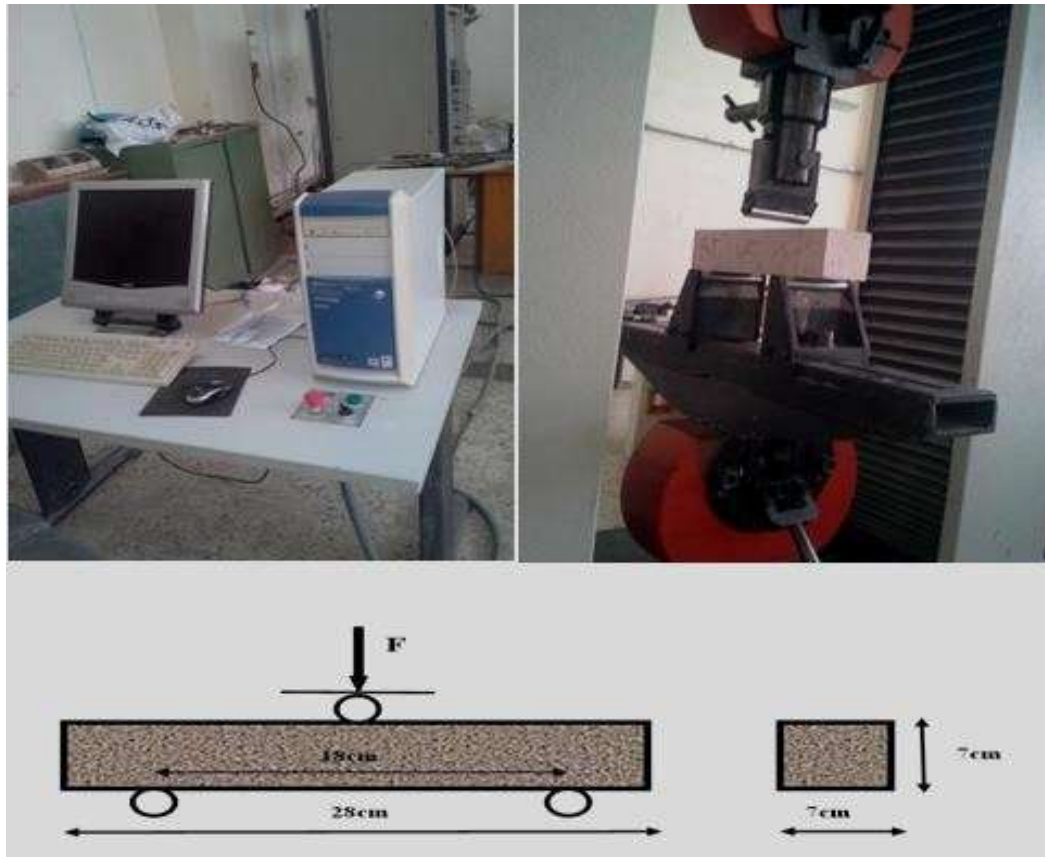
Figure.III.19: Dispositif expérimental pour l'essai de traction par flexion 3 points.
