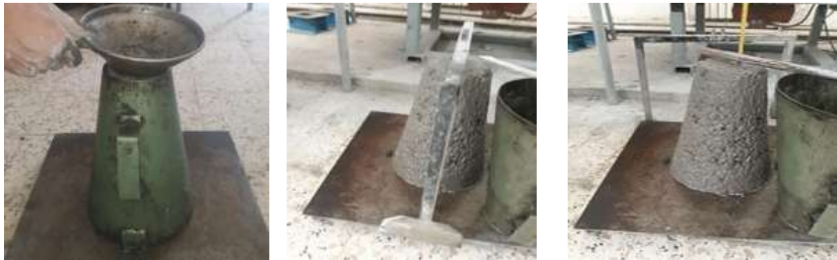
Figure.III.14 : Détermination de d’affaissement du béton à l’état frais.
