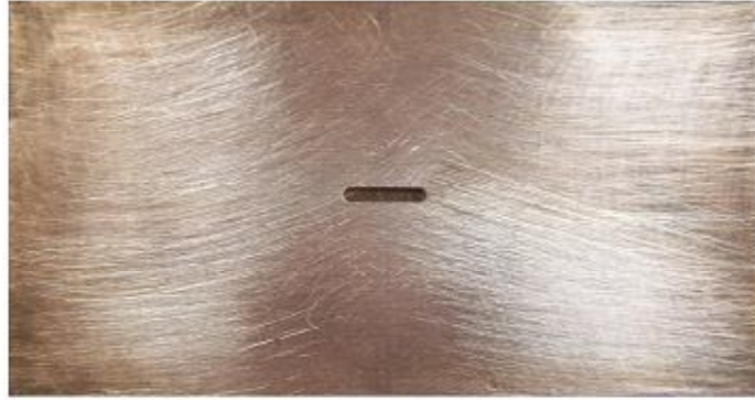
Figure (IV.9) : plaque de cuivre avec défaut.
