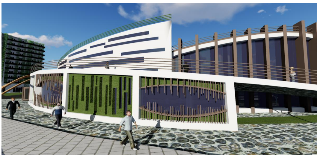
Figure 106: façade végétalisée avec des brises soleils en roseau .
