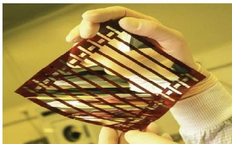
Figure II-9 : Cellule solaire tout organique sur substrat souple.
