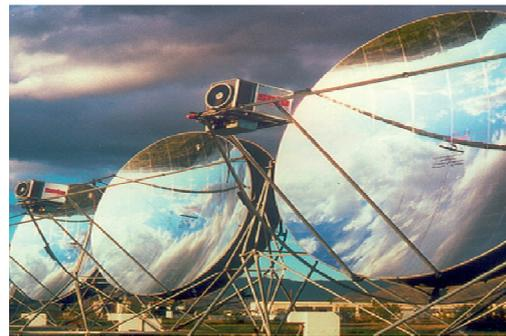
*Capteurs thermodynamique paraboliques*
