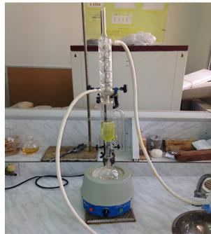
**Figure 7:** Extraction des extractibles à l'éthanol/toluène (Belkacem et Ameyoud, 2015)
