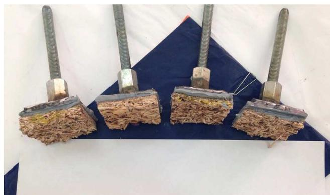
**Figure 23:** Eprouvettes décollées après traction perpendiculaire (Belkacem et Ameyoud, 2015).
