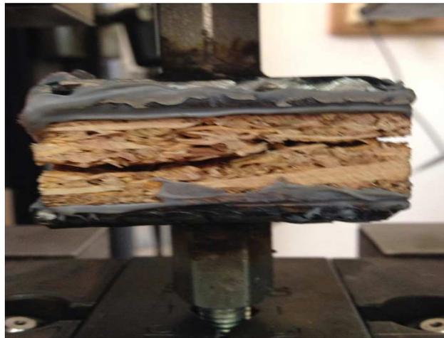
**Figure 22:** Fissure de l'éprouvette après traction perpendiculaire (Ameyoud et Belkacem, 2015).
