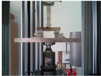
**Figure 20:** Fissure de l'éprouvette après l'essai de flexion (Belkacem et Ameyoud, 2015).
