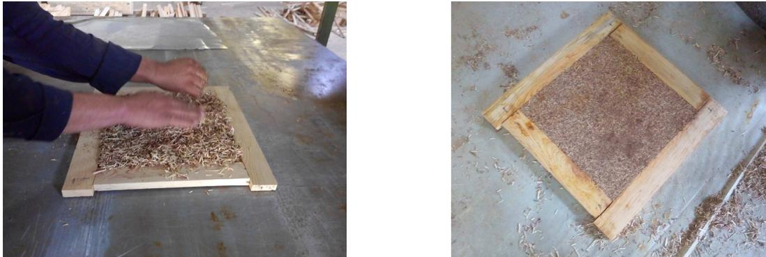
**Figure 15:** Pressage des particules du Ciste de Montpellier (Belkacem et Ameyoud, 2015).
