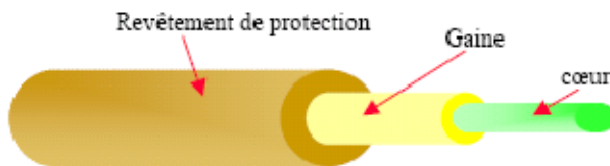
Figure. II.15 : Constitution générale d'une fibre optique.
