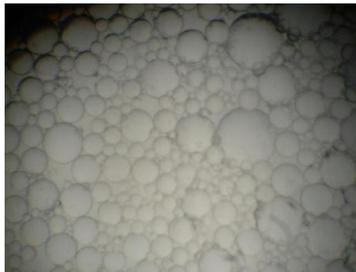
**Figure 22: Observation de l'émulsion du E<sub>24</sub> pour le milieu à base de têtes de sardine au microscope optique au grossissement x 1000.**
