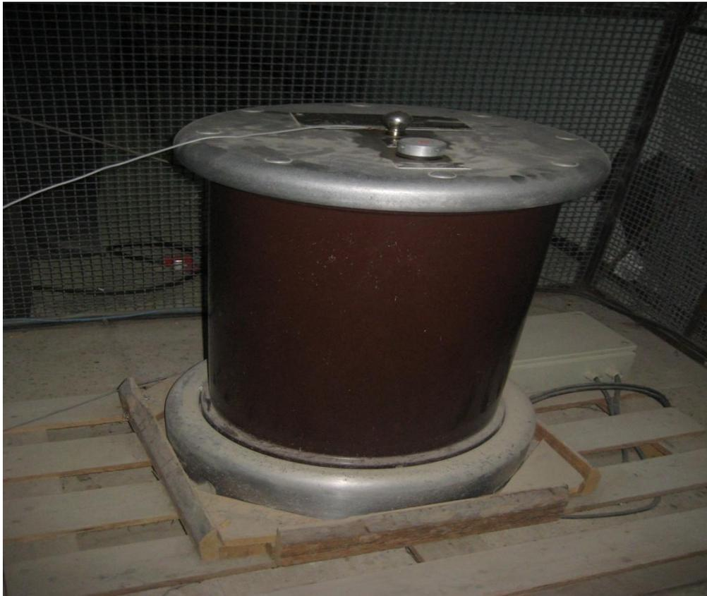
Image du Transformateur d'essai
