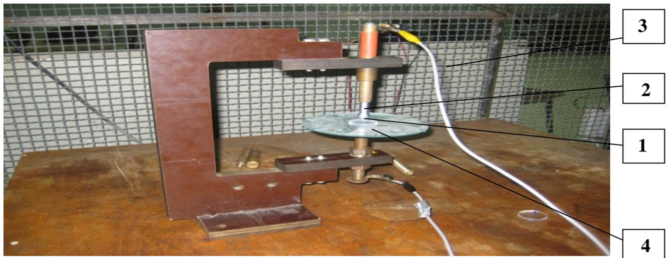
**1** Echantillon des polymères utilisés (PVC et PMMA)
