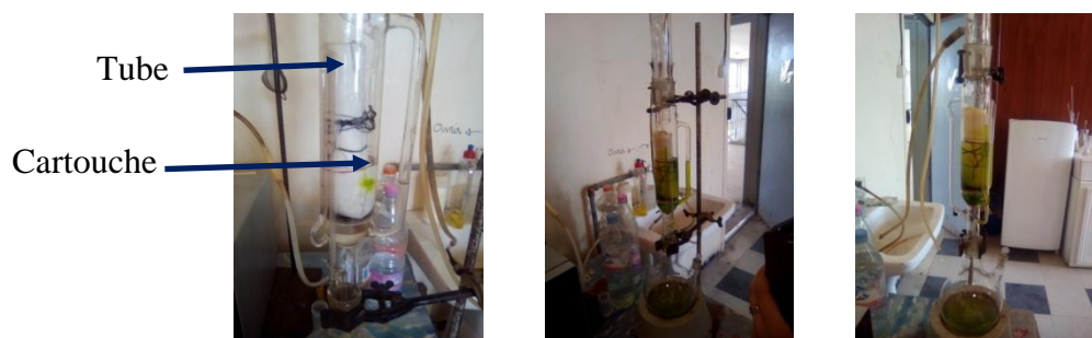
Figure 17 : Procédé d'extraction par Soxhlet.
