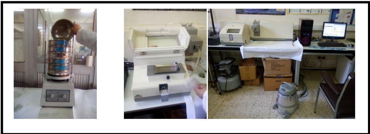
Figure 9 : tamiseuse de marque Vibro. MASTER poudre + tamis.
