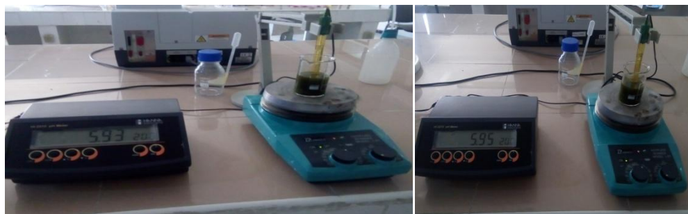
Figure 14 : pH-mètre électronique (Hanna Instruments Digital, Bench-model pH Mètre Model HI-2210).
