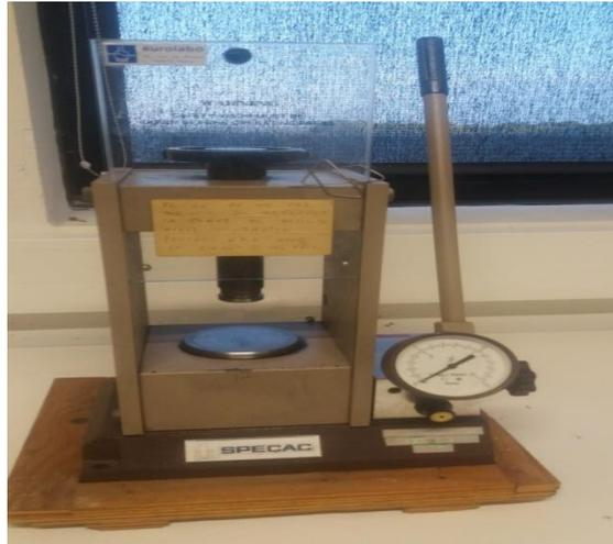
**Figure II.2 :** Photo de la presse uni axiale MPA 250
