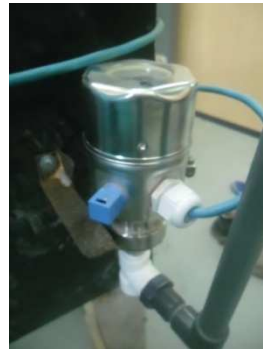
Figure II.16 : Présentation d'un transmetteur de pression cerabarM
