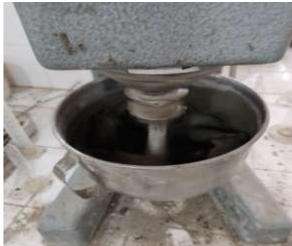
Figure IV.19 : mélange du mortier dans un malaxeur électrique.
