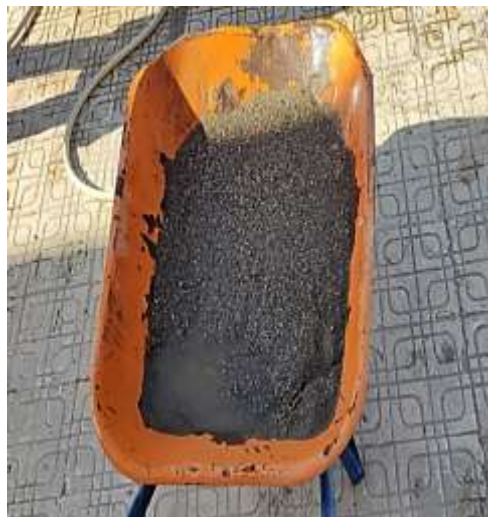
Figure IV.2 : Lavage du sable de rivière et sable de dune pour éliminer les impuretés.
