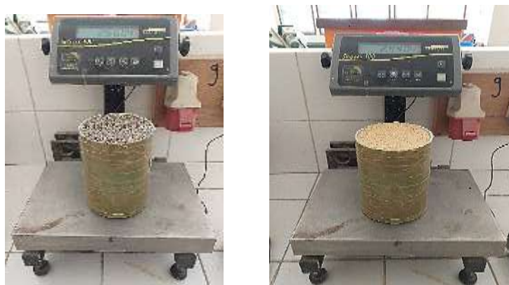
Figure IV.16 : Masse volumique apparente mesurée au niveau du laboratoire béton-UMMTO.
