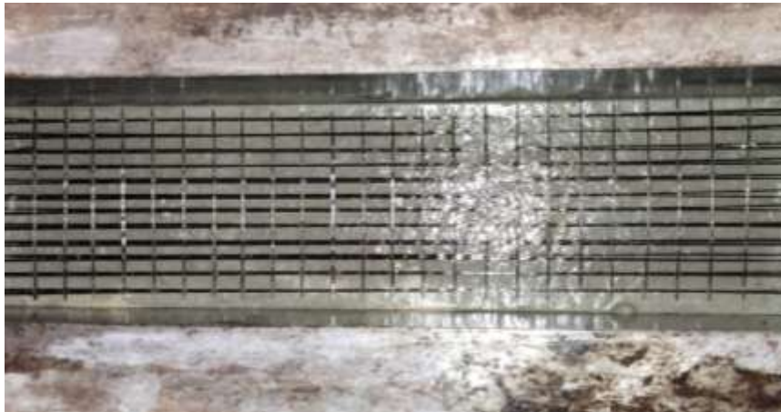
Figure IV.23 : Placement du tissu découpé et enduit de résine sur la couche de mortier dans les moules.
