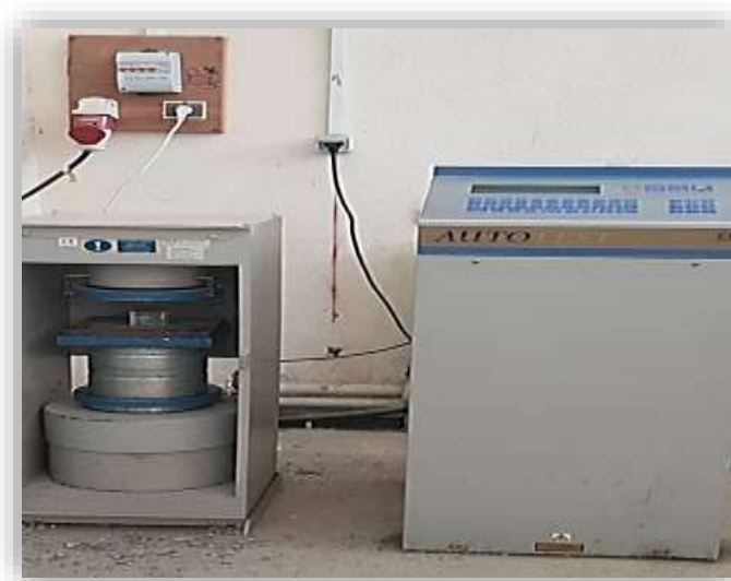
Figure IV-28 : Mise en place des éprouvettes cubiques sur la machine de compression AUTOTEST .
