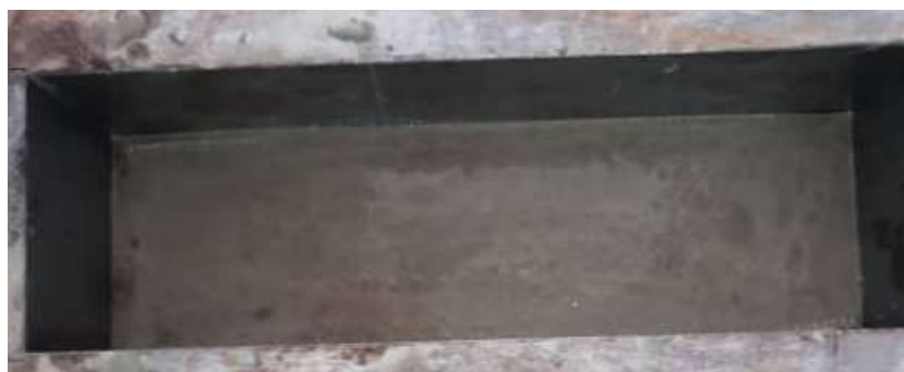
Figure IV.22 : Versement de la moitié du mortier préparé dans les moules prismatiques.
