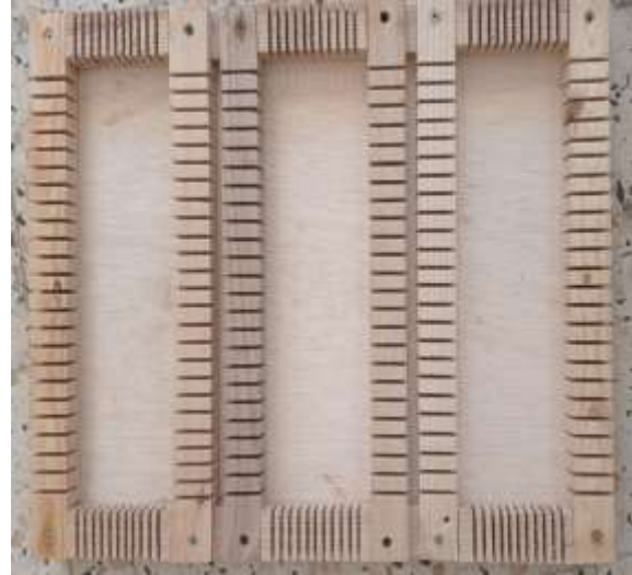
Figure IV.7 : Moule spécialement conçu pour tissage de la fibre de carbone.
