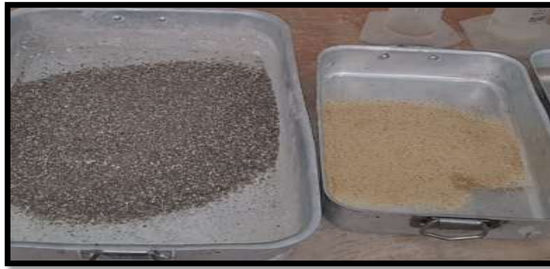
Figure IV.5 : Sable de rivière et sable de dune après séchage et tamisage au laboratoire UMMTO
