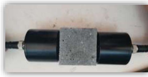
Figure V.1 : Mesure en transmission directe
