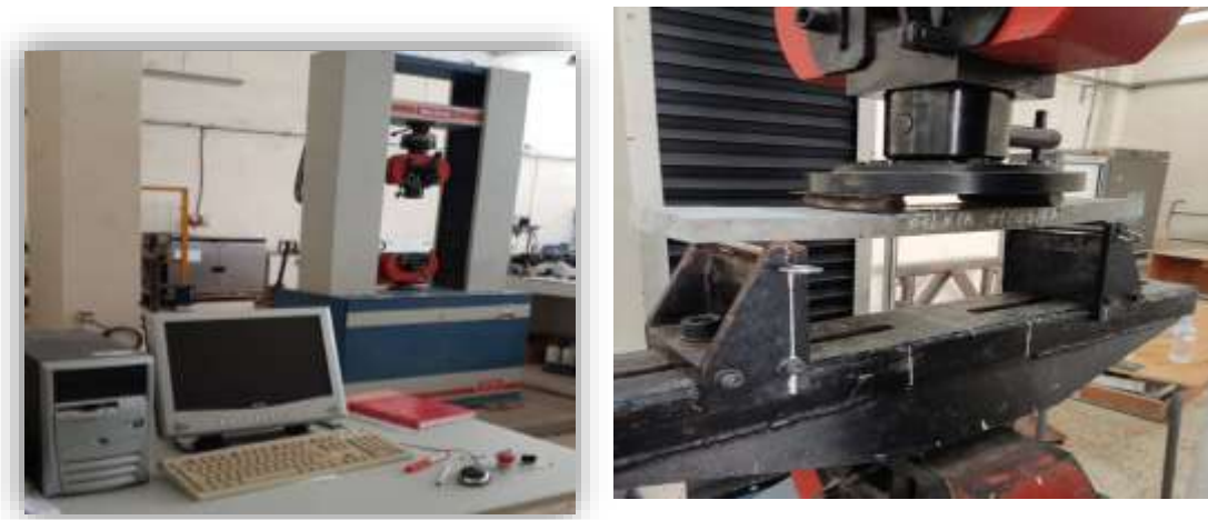
Figure IV.27 : Dispositif pour l'essai de résistance à la flexion (4 points).
