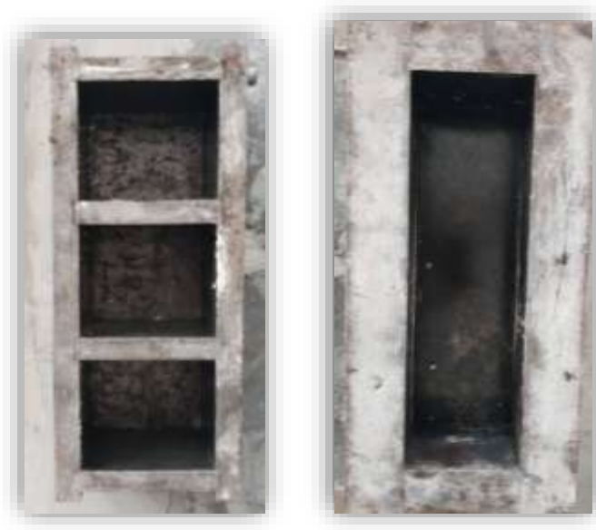
Figure IV.20 : a) Moule cubique (5x5x5) cm 3 . b) Moule prismatique (2x10x40) cm 3
