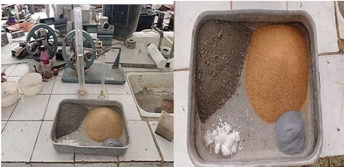
Figure IV.18 : Préparation des différents constituants du mortier (sable, ciment, fumée de silice, fibre courte, super plastifiant).
