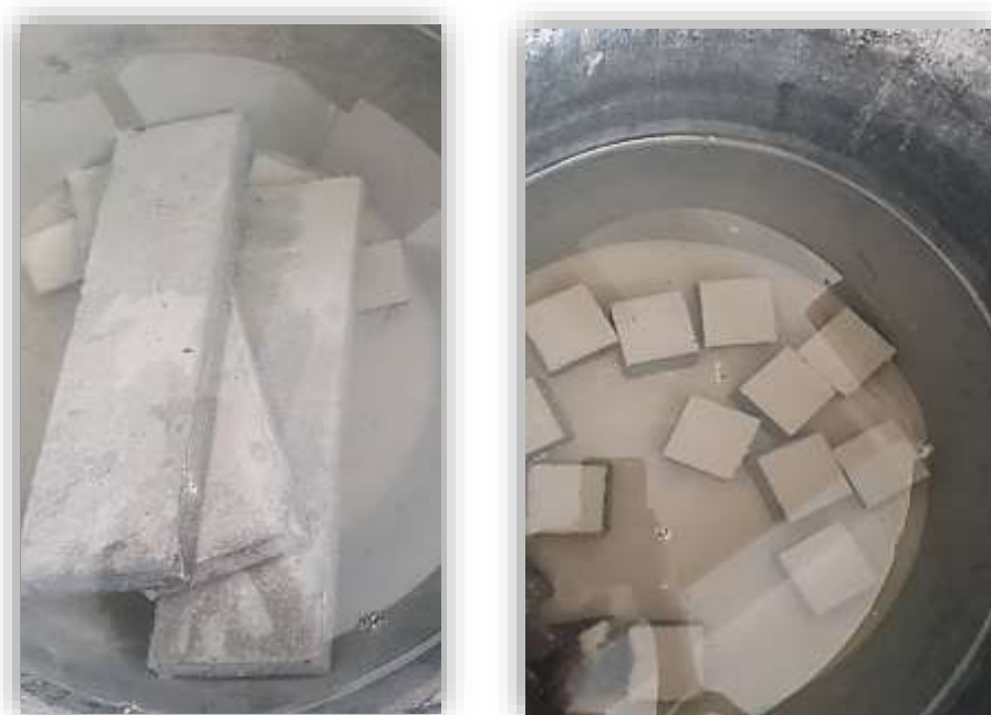
Figure IV.24 : Conservation des éprouvettes dans l'eau.
