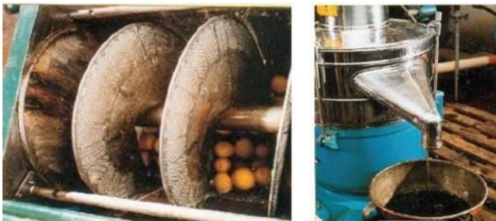
Figure 7 : Photos à gauche d'une Pelatrice et à droite d'une centrifugeuse séparatrice de l'essence de citrus des eaux résiduelles (Kimball, 1999 ; Dugo et Di Giacomo, 2002).
