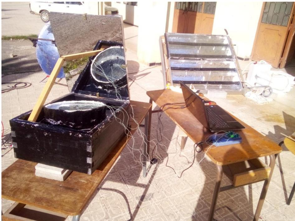
**Figure IV.15 : Mise en place des thermocouples.**
