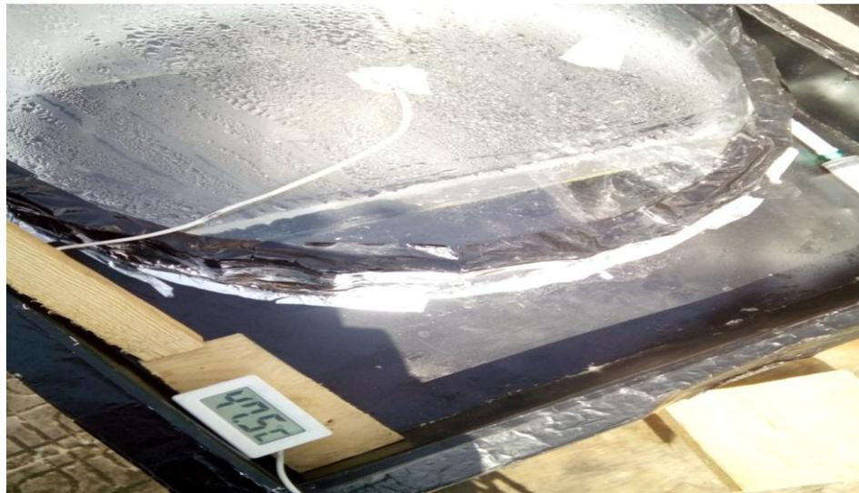
**Figure IV.9 : Glissement des gouttelettes (au cours du 3<sup>ème</sup> test).**
