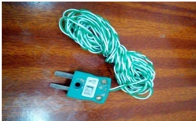
**Figure III.12 : thermocouple de type K.**
