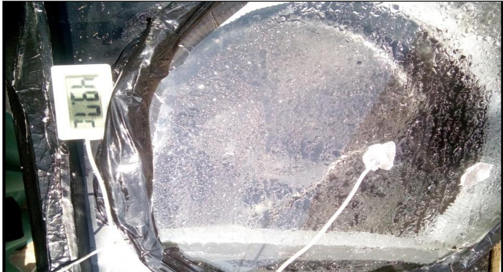
Figure IV.13: Glissement des gouttelettes. (4<sup>ème</sup> test)
