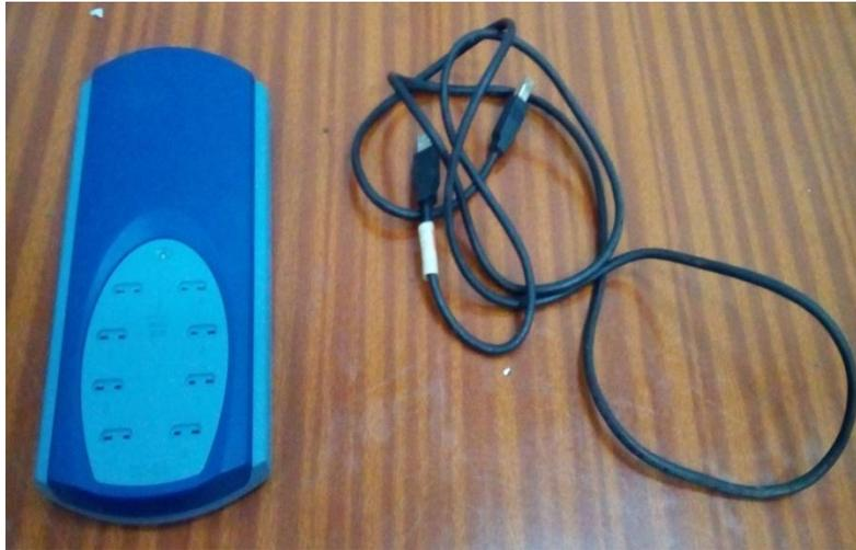
**Figure III.12: Pico Technology Enregistreur de données, Température.**
