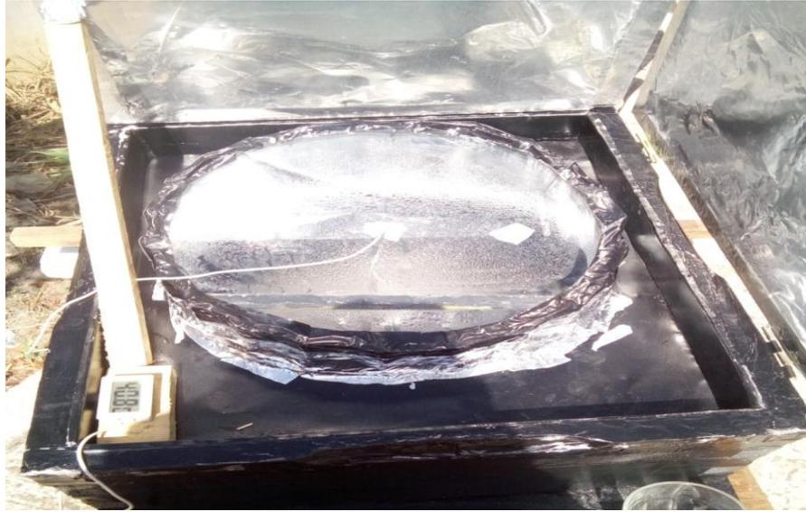
**Figure IV.8: Apparition des premières gouttes. (3<sup>ème</sup> test)**
