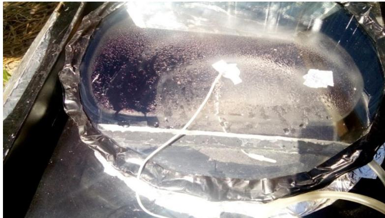
Figure IV.5 : La formation des gouttes. (2<sup>ème</sup> test)
