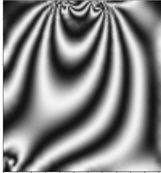
Figure V.27 : Isochromes obtenues numériquement et traitées avec SURFER
