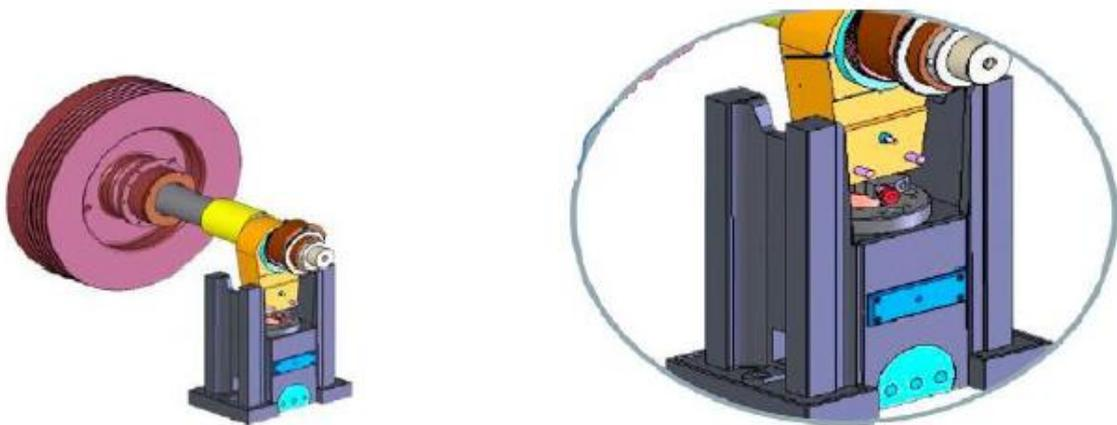
Figure III.43 : Exemple du Système Excentrique dans une Presse
