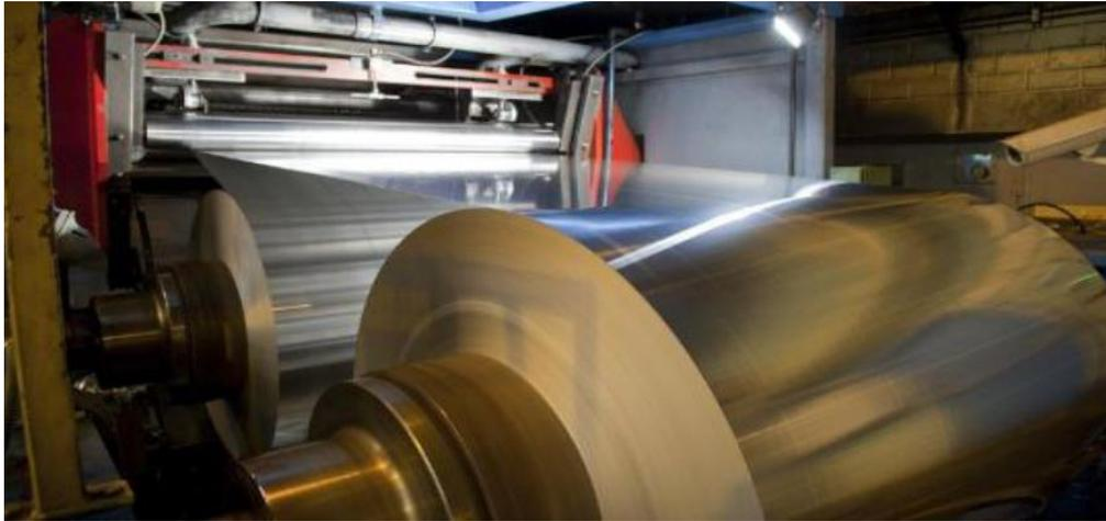
Figure I.5 : laminage à froid
