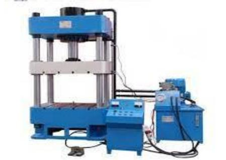
Figure III.46 : Presses à colonne
