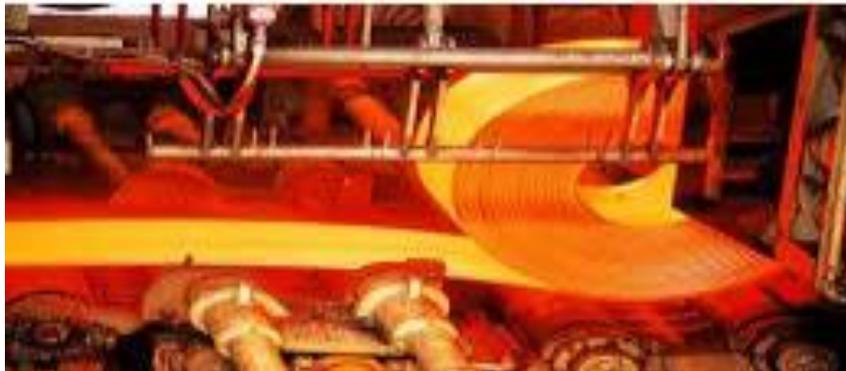
Figure I.4 : laminage à chaud
