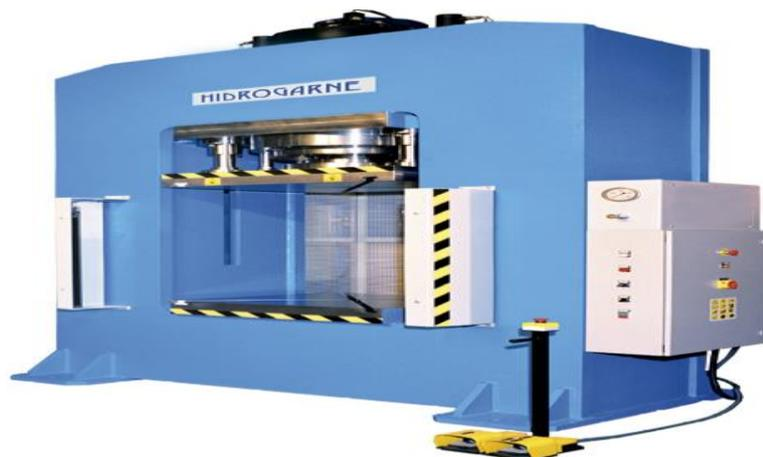
Figure III.51 : Presses double effet
