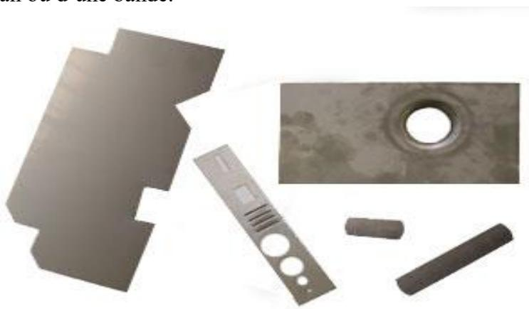
Figure 1 II.15 Encochage des tôles
