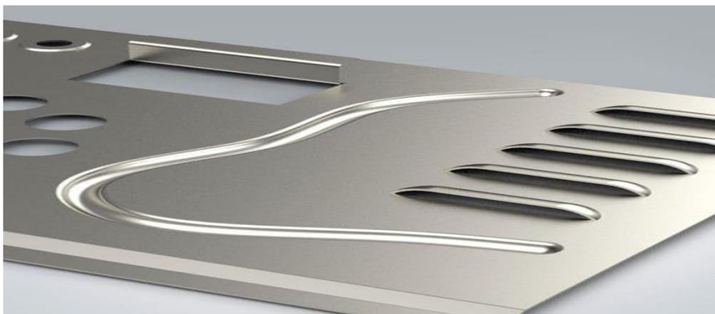
Figure II.14 : le grignotage de la tôle
