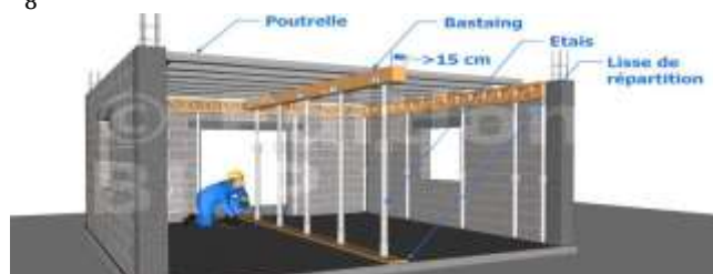
Figure III.2 : Disposition idéale des étais
