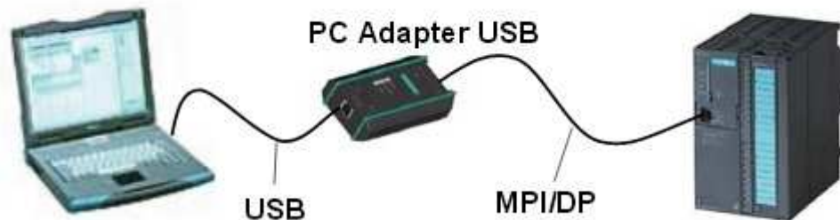
Figure1. Communication PC avec automate via réseau MPI
