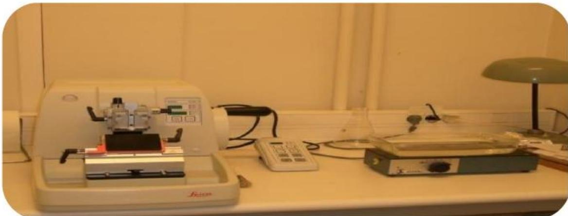
**Figure 21** : Photographie d'un microtome à gauche et du bain Marie à droite.
