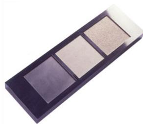
**Fig. III.4 :** Etat de surface obtenue par électroérosion.
