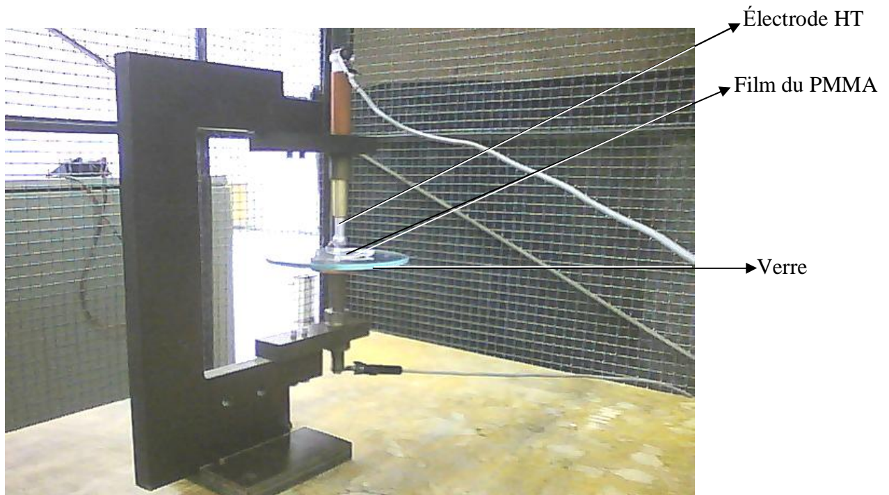
Fig.V.2 Electrodes et support en bakélite
