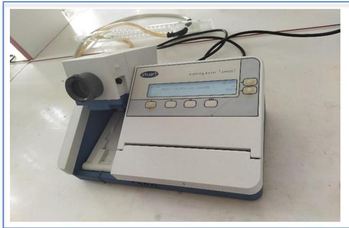
Figure 38 : Appareil de mesure du point de fusion
