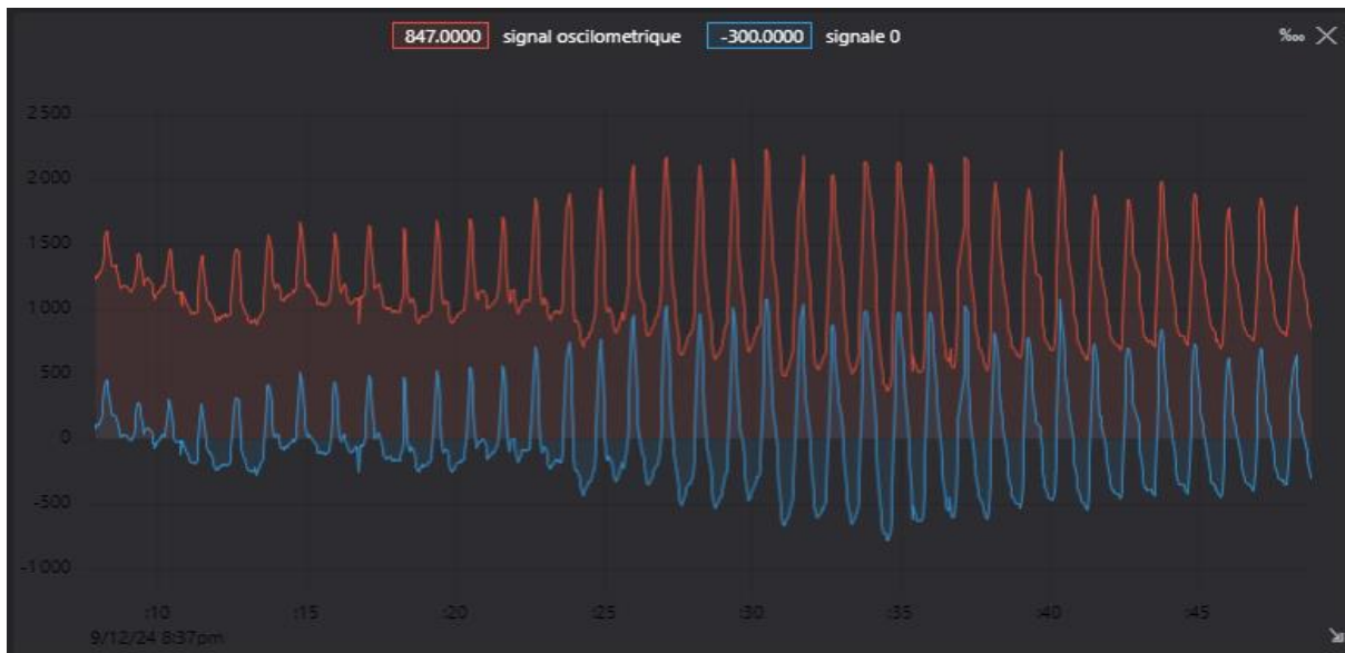
Figure III-13 la figure nous montre le signal lu avec l'esp32 en rouge et le signal recentré à 0/
