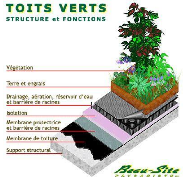
Figure 13 : structure et fonction du toit vert
