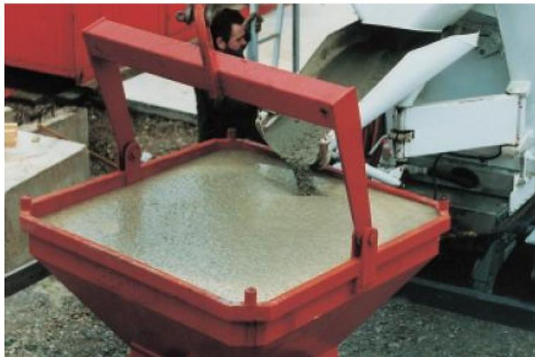
**Figure 1.1** : Aspect d'un béton autoplaçant à l'état frais.
