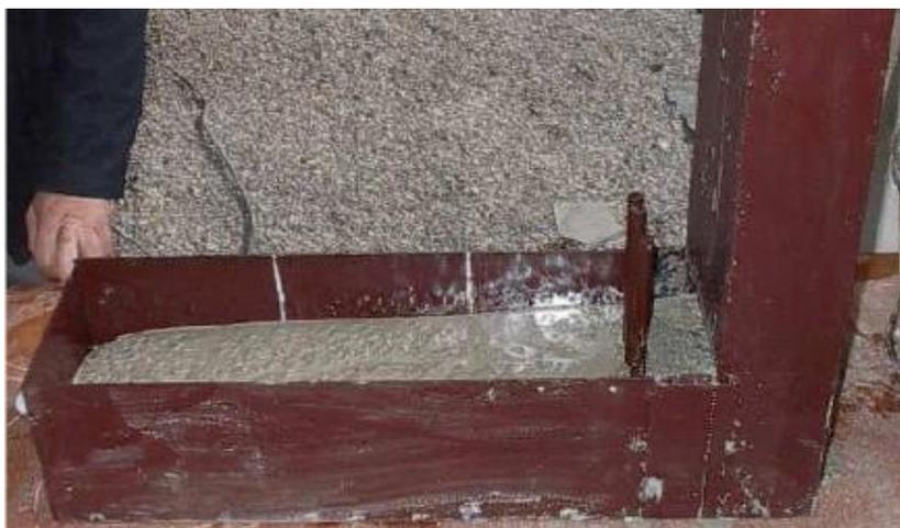
**Figure 4.4 :** L'essai à la boîte en L.
