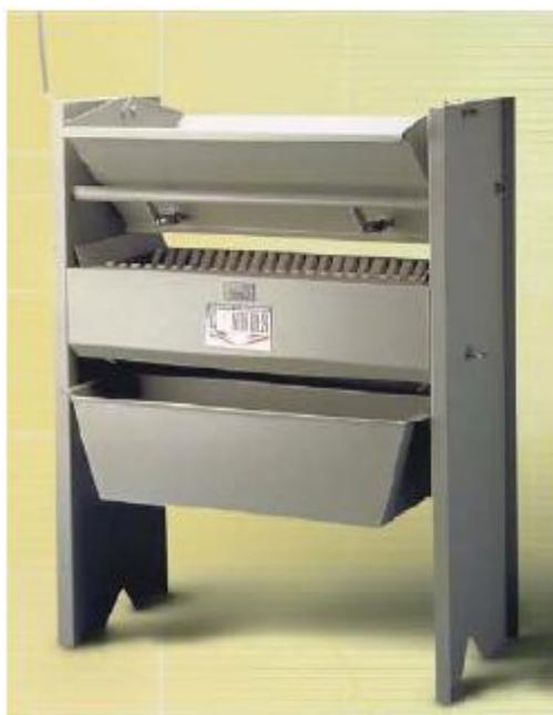
Figure 4.1 : Echantillonneur [50].
