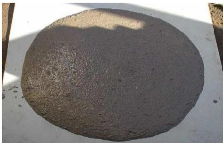
**Figure 4.2 :** Etalement d'un béton autoplaçant.
