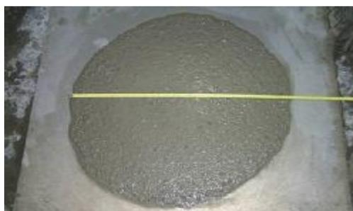
**Figure 4.3 :** Essai d'étalement.
