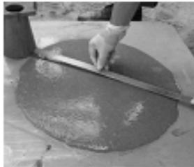
(a) Cône à mortier
