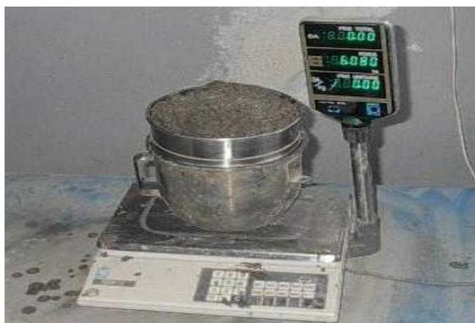
**Figure 4.5 :** Essai de stabilité au tamis.
