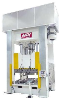
Figure I.10 : Presse à triple effet. [6]
