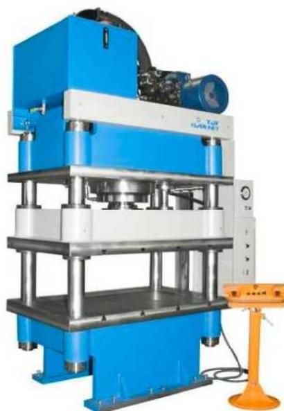
Figure I.06 : Presse à colonnes. [6]
