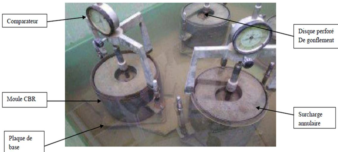
Figure IV.17 : Essai CBR après immersion, imbibition et gonflement.
