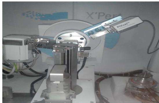
Figure III.19 : Un diffractomètre.
