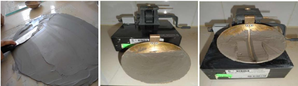
Figure III.16 : Détermination de la limite de liquidité.
