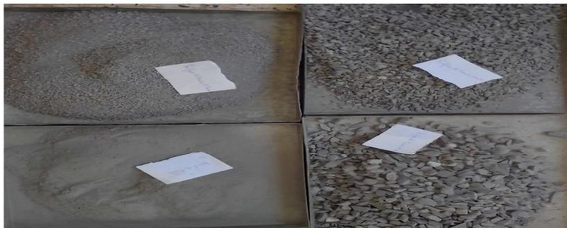
Figure III.10 : Granulats de schiste après concassage et tamisage.
