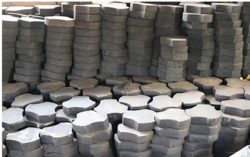
Figure II.8. : Pavés fabriqués à partir de déchets plastiques [46].
