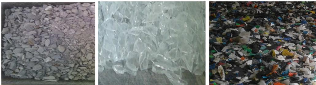
Figure III.1 : Matériaux utilisés les granulats de schiste, déchets plastique et débris de verre.
