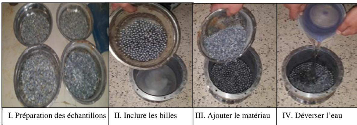
Figure V.2 : Mode opératoire d'essai micro Deval.
