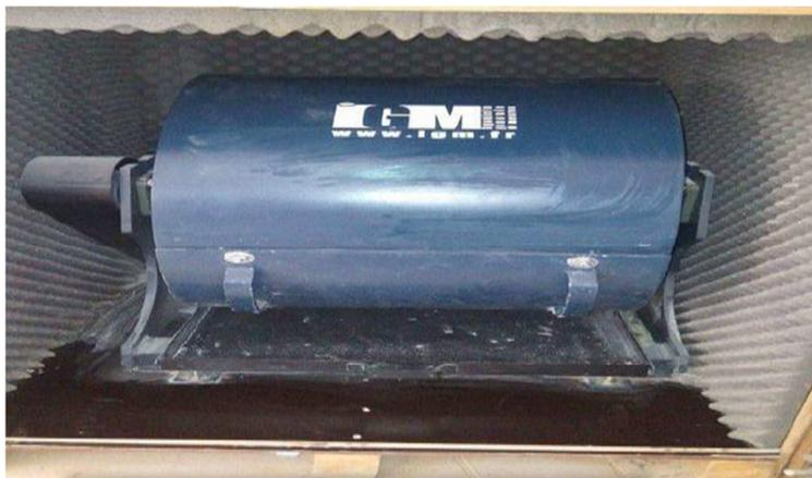
Figure V.4 : Machine d'essai Los Angeles.
