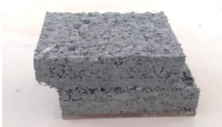
Figure VI.9 : Échantillon après cisaillement.
