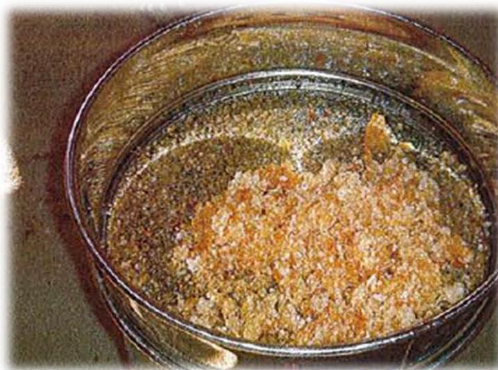
**Figure 14** : Filtre situé dans la partie supérieure du maturateur (Clemence, 2005).
