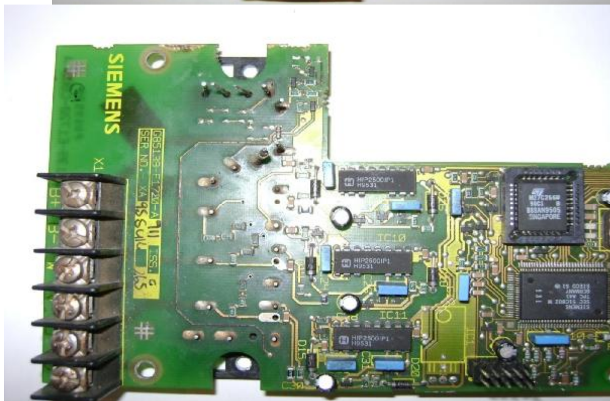
Fig2.18.a circuit de commande du variateur de vitesse micro master siemens
