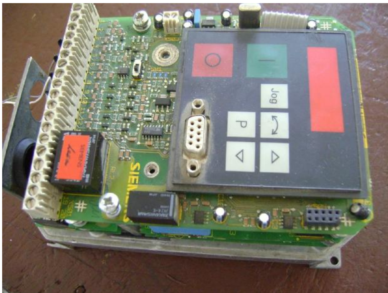
Fig 2.16.B circuit interne du Micromaster
