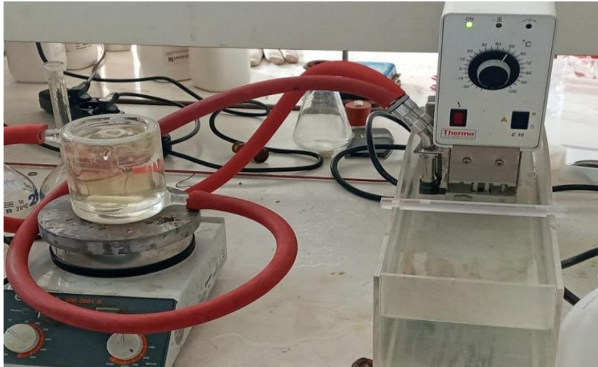
Figure IV.2 : Montage expérimental du procédé Fenton.
