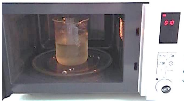
Figure IV.3 : Dispositif expérimental de procédé Fenton assisté par micro-onde.
