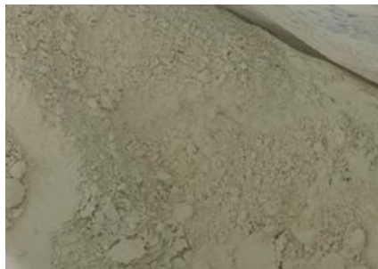
Figure 38 : le ciment utilisé (ciment blanc).
