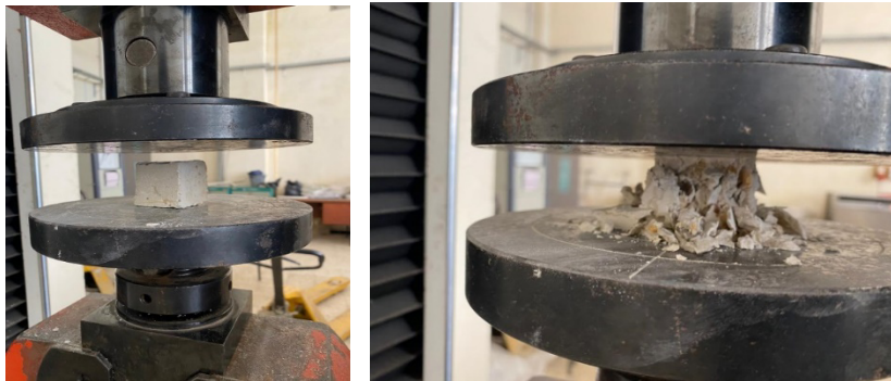
Figure 54 : photo montrant le teste de la compression sur l'échantillon.
