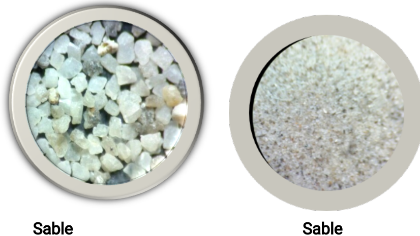
Figure 33 : granulométrie du sable de la digue d'El Abed.
