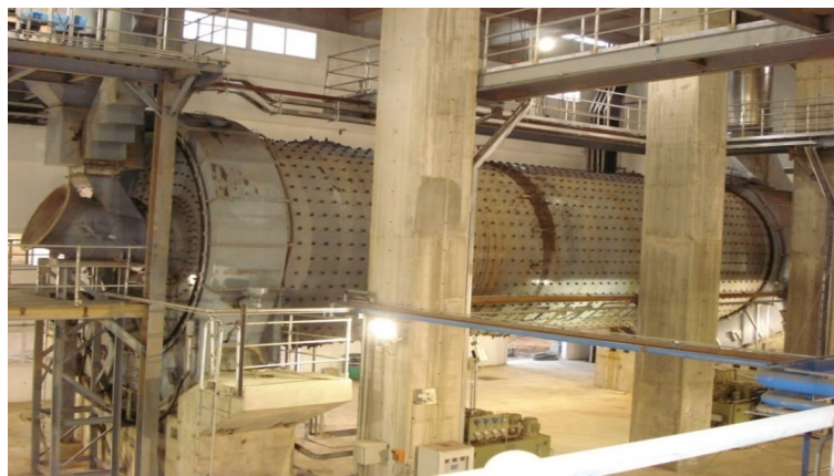
Figure 18 : image montrant un broyeur à boulets (Google).
