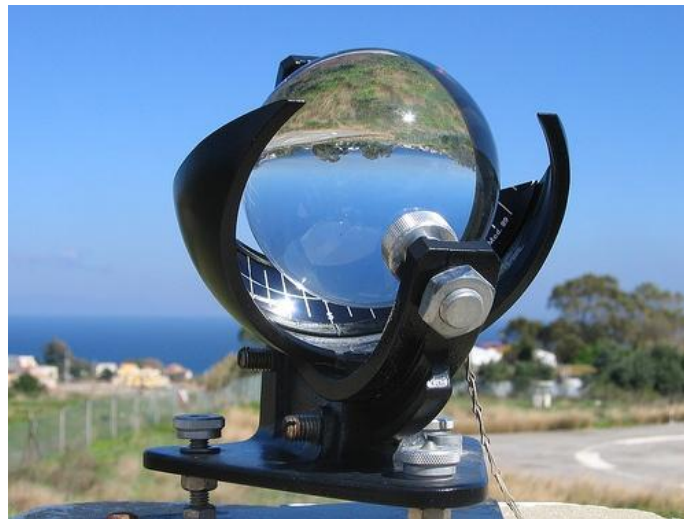
Figure (1.5) : l'héliographe de Campbell– Stokes.
