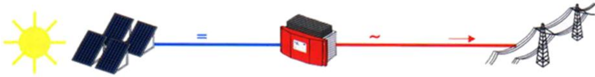
Figure (2.4) : onduleur dans un système PV
