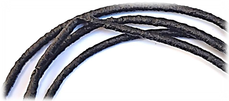
Figure III.12 : Les ruptures sur le filament 5 (Composite de 95% PEHD et 5% poudre de bois)
