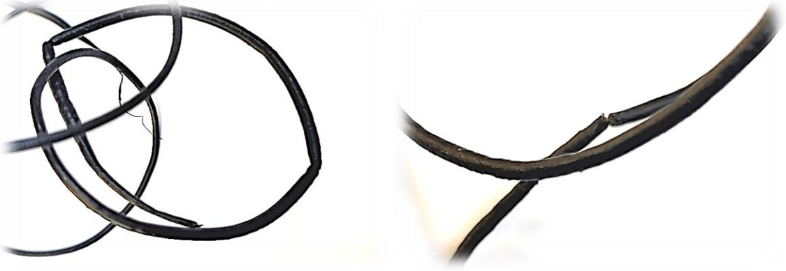
Figure III.11: Les ruptures sur le filament 4 (Composite de 80% PEHD et 20% poudre de bois).
