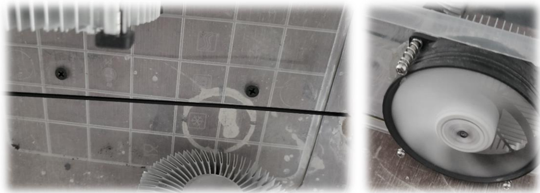
Figure III.6 : Système de refroidissement des filaments extrudés
