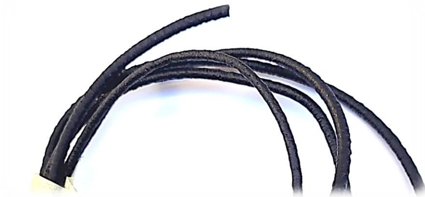
Figure III.13: Les ruptures sur le filament 6 (Composite de 98% PEHD et 2% poudre de bois)
