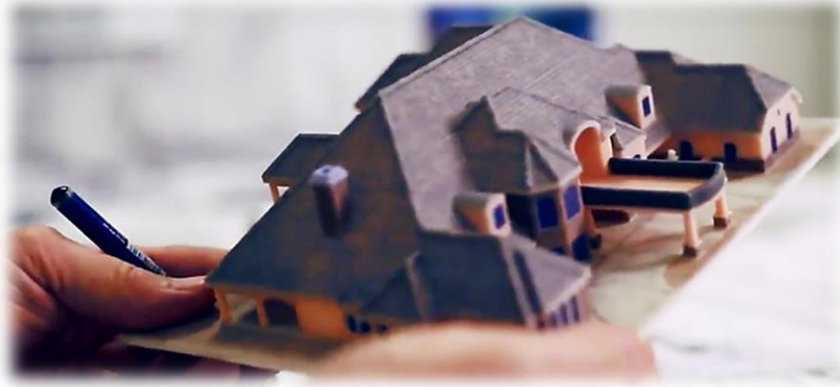
Figure 1.3 : Une Maquette d'architecte imprimée en 3D (Maison)
