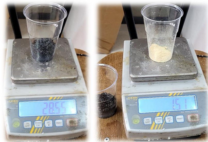
Figure III.4 : La préparation du dosage 95% PEHD et 5% poudre de bois. Pour 30g de métiers premiers
