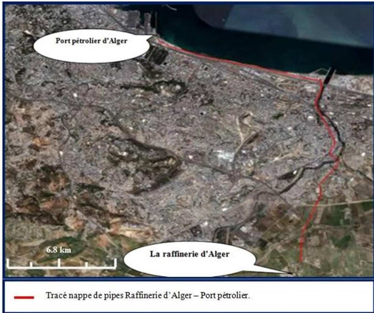
Fig.2.9 Vue aérienne générale de la raffinerie d'Alger (Sidi Rezine) RA1G et du port pétrolier avec les parties aériennes de la nappe de pipes (Google Earth, 2016).
