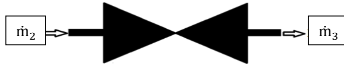
Figure (3.6) schéma d'une vanne de détente.
