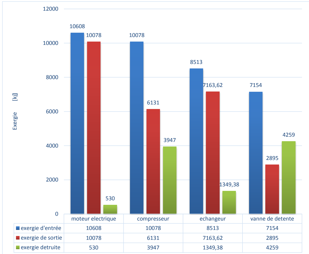
Figure (3.12) représentation des flux exergétiques entrant, sortant et irréversibilités dans chaque composant du système.
