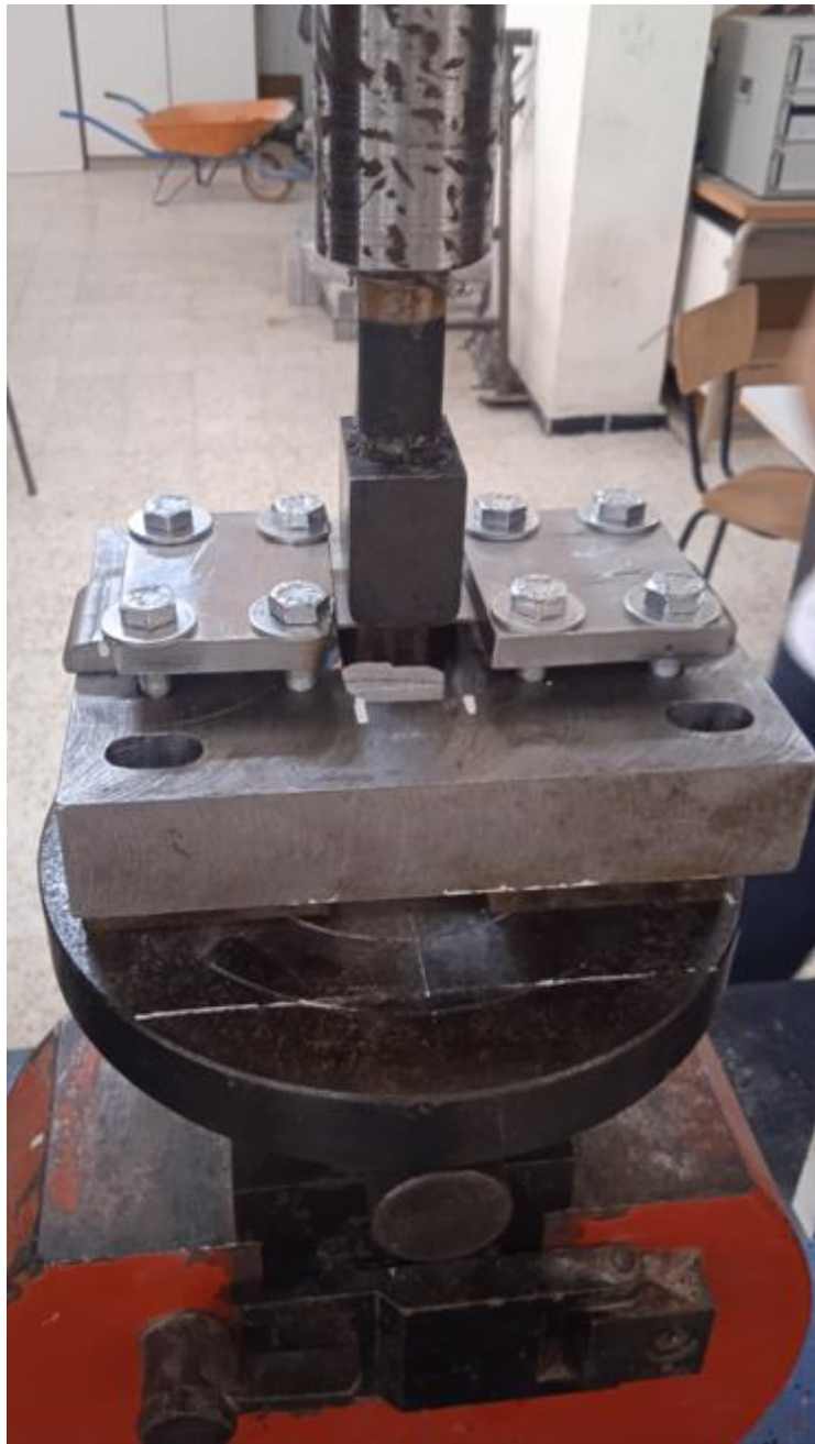
Figure II.16 Montage de l'outil de pliage sur la machine
