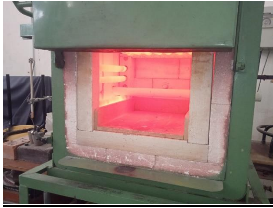
Figure II. 2 four à trempe
