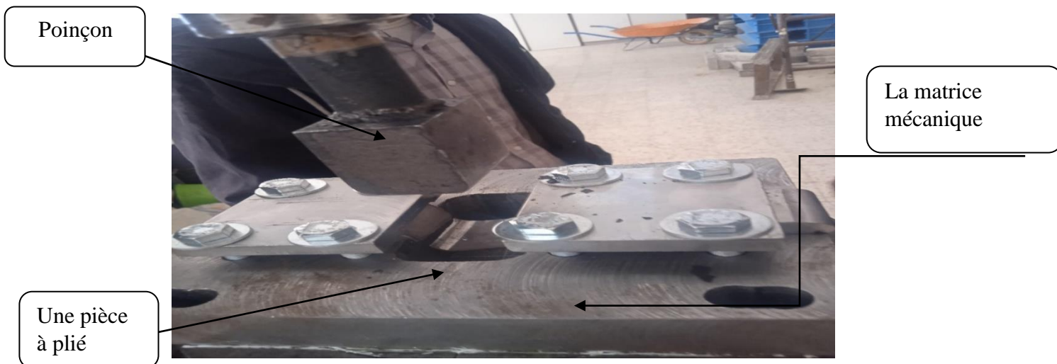
Figure II. 8 Dispositif utilisé pour l'essai pliage avec une matrice et un poinçon.
