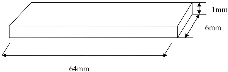
**Figure II.4 éprouvette pour les essais de frottement interne**
