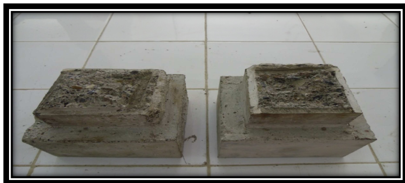
Etape 3 : Les surfaces de l'éprouvette après la rupture totale. « Etapes de l'essai de traction directe »
