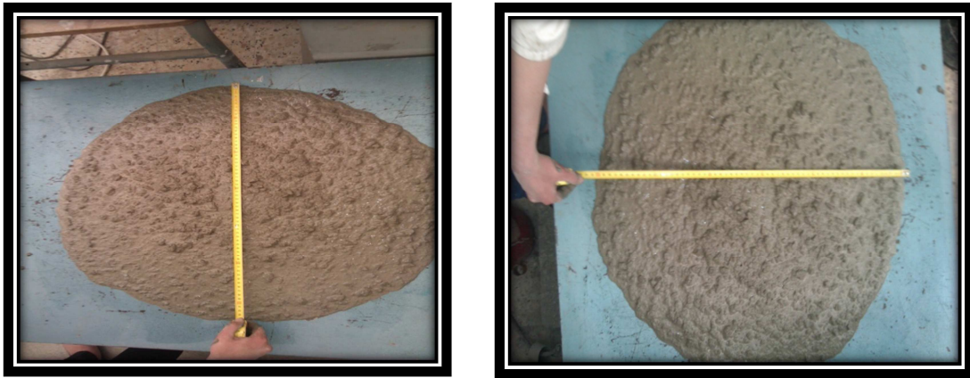
Figure II-3 : étalement d'un BAP.
