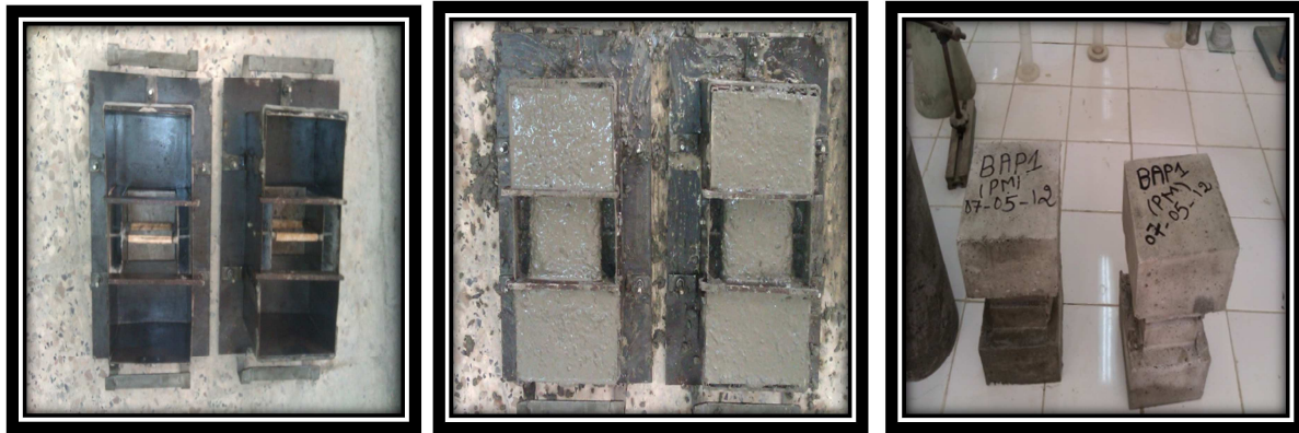
Figure II-2: Moules graissés à l'aide d'une huile, remplissage des moules, apparence des éprouvettes après le décoffrage.
