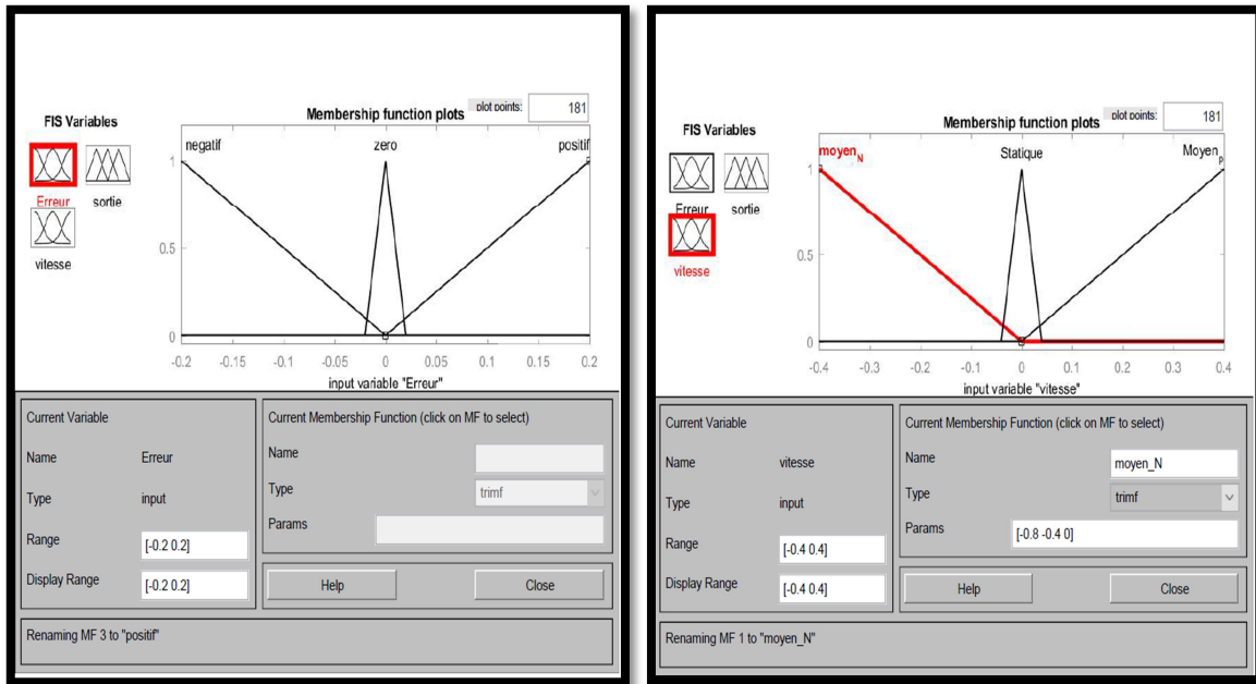
Figure III.22: Entrées du régulateur flou de l'angle \theta .
