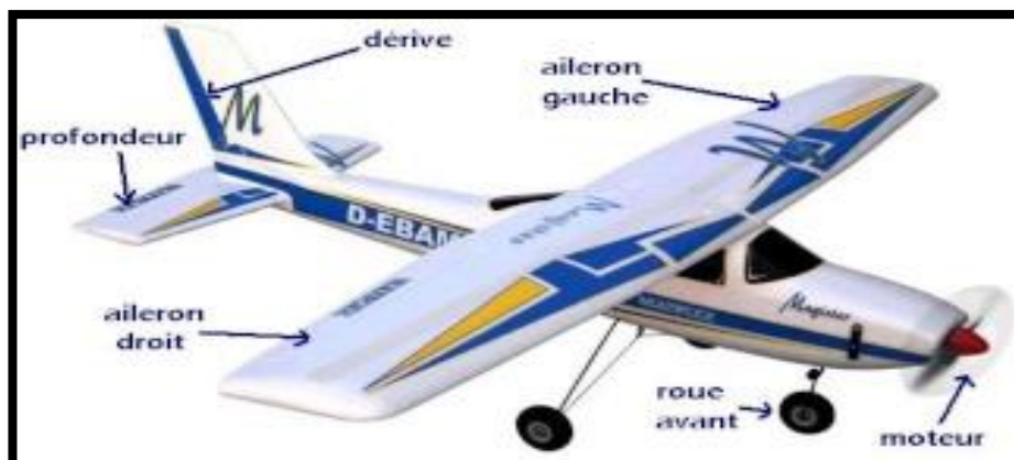
Figure I.11: Principales composantes d'un aéronef.
