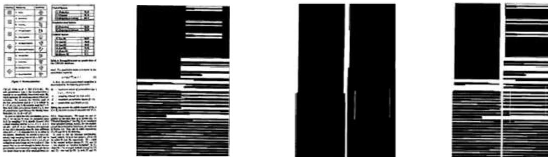
a : Image original    b : Lissage horizontal    c : Lissage vertical    d : Le ET logique entre (b) et (c)
